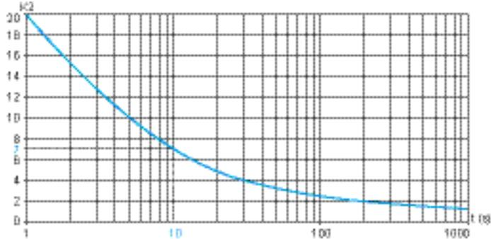
Из графика № 2 определяется коэффициент  $K_2$ , соответствующий времени торможения  $10 \text{ с}$ .
