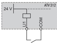
Положение CL1 с транзисторными выходами контроллера
