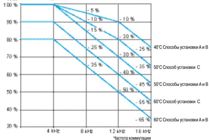
Для промежуточных значений температур (например, 55 °C) интерполируйте значение между двумя кривыми.
