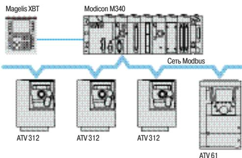
Пример конфигурации на шине Modbus
